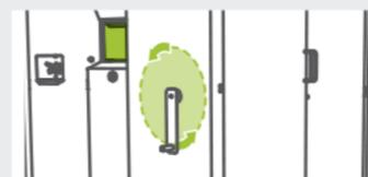
À la fermeture de la porte, un nouveau cycle s'enclenche par simple rotation. La station est équipée d'une manivelle et d'un système d'engrenage qui permet une rotation manuelle aisée sans électricité.
