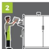
Incorporer les déchets dans une cuve inox d'un volume de 500 litres tels que les restes de légumes, de fruits, de pâtes, de riz, de viandes ou de poissons et autres denrées solides.
